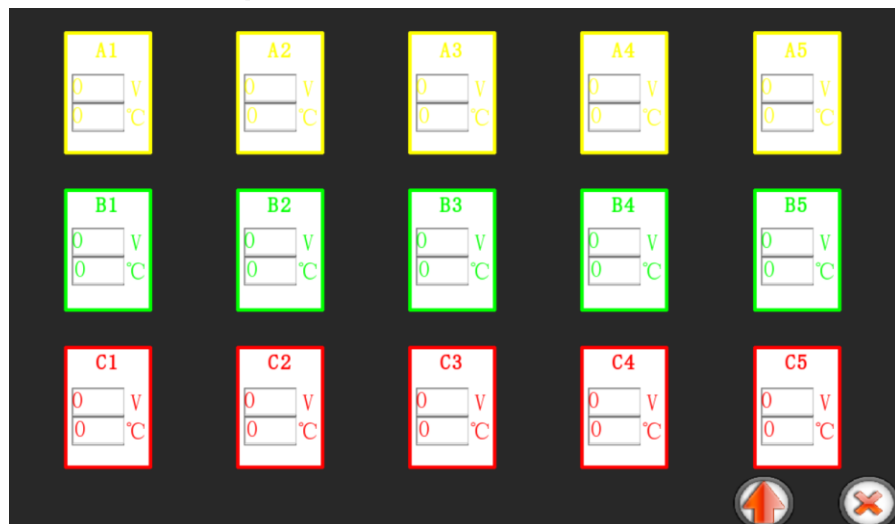
Рис. 56. Состояние параметров силовых ячеек
