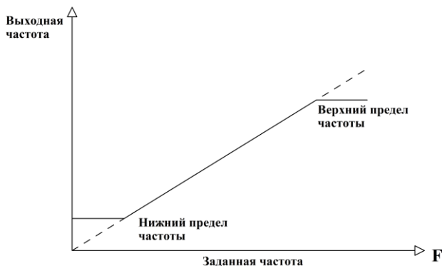
Рис. 41. Соотношение между верхним пределом и нижним пределом частоты, заданной частотой и выходной частотой
